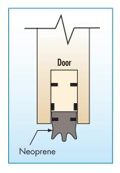
Figure 3-34: Automatic door bottom
